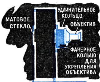
Рис. 4. Разрез вспомогательной камеры.
